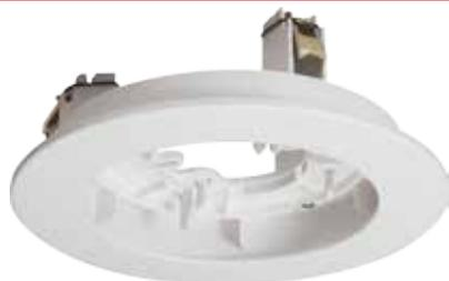
Das uP-Gehäuse für IQ8Quad Meldersockel wird zum Einbau des IQ8Quad und ES Detect Melders in abgehängte Decken eingesetzt oder dort, wo eine verdeckte Montage des Meldersockels (Art.-Nr. 805590, 805591) erforderlich ist. Der Meldersockel zur Aufnahme des IQ8Quad Melders wird in das uP-Gehäuse eingerastet und durch den aufgesetzten Abdeckring nach außen hin optisch abgeschlossen. Der Meldersockel ist somit nicht mehr sichtbar.
