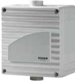
Schalldämpfer für die Geräuschreduktion von TITANUS EB-Rauchansaugsystemen in geräuschsensiblen Applikationen. Der Schalldämpfer wird am Rohrausgang angeschlossen, er reduziert das Betriebsgeräusch um bis zu 10 dB(A). Die Montage erfolgt entweder direkt am Luftauslass des Geräts oder mit einem Abstand von bis zu maximal 10 cm zum Luftauslass.
