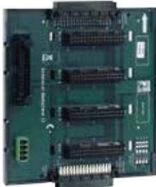
Modulträger in Kunststoff-Montagewanne zur Aufnahme von bis zu vier Modulen. Der verlagerte Anschluss erfolgte über eine steckbare Verbindung per vorkonfektioniertem Kabel an abgesetzten Anschluss terminals.
