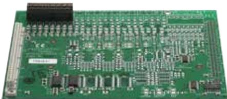
Das Erweiterungsmodul wird auf das Interfaceboard der Zentrale gesteckt. Das Erweiterungsmodul kann ausschließlich auf den Systemstecker 1 des Interfaceboards der Zentrale verwendet werden.
