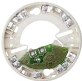
Meldersockel mit Relaiskontaktausgang, für Melderfamilie ES Detect. Geeignet für 48-V-DC-Betrieb. Kontakt: potentialfreier Öffner oder Schließer durch Kodierbrücke wählbar, werkseitige Einstellung: Öffner. Eine typische Anwendung für diesen Sockel mit ES Detect Melder ist die Überwachung von Mobilfunkstationen.
