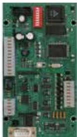
Wie 784744 jedoch zur Einbindung einer weiteren BMZ in einen vorhandenen redundanten Bus eines FAT 3000 an einer Adapterbaugruppe ADP-N3E. Im Unterschied zum ADP-N3E stellt die ADP-N3S keine Spannungsversorgung für den redundanten Betrieb bereit.
