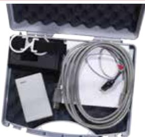
Diagnosetool für TITANUS EB-Rauchansaugsysteme zum Auslesen von Messdaten und Gerätekonfigurationen sowie zur Lokalisierung von Störungen.
