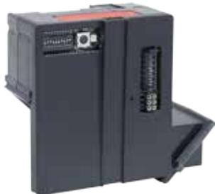
Detektormodul für den Einsatz in TITANUS TOP SENS®-Rauchansaugsystemen (Art.-Nr. 801531.10, 801532.10) mit einer Ansprechsensibilität von 0,5 % Lichttrübung pro m. Brandfrüherkennung über HPLS-Technologie. Werkzeugloser Einbau in die TITANUS TOP SENS® EB-Systeme und über DIL-Schalter an der Außenseite des Detektormoduls einstellbar. Über die Parametriermöglichkeit am Modul kann die Sensibilität des Rauchansaugsystems verändert werden.
