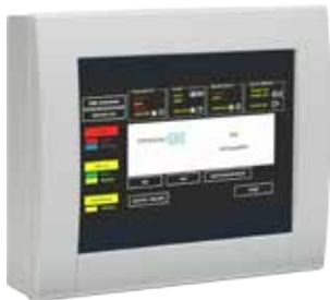
Hochwertiges Anzeige- und Bedienteil für den Betrieb an einer Brandmelderzentrale FlexES Control. Die Bedienung des Systems erfolgt dialoggeführt und intuitiv über das berührungssensitive 7"-Farbdisplay. Individuelle Zugangsebenen können per Tastaturcode aktiviert werden. Die Montage erfolgt auf Putz.
