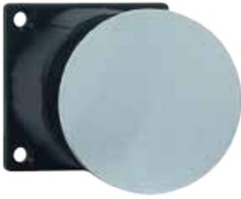
Ankerplatte mit Teleskop für Haftmagnete mit 50 mm Durchmesser. Die eigentliche Platte ist mithilfe einer eingebauten Feder (Federweg ca. 20 mm) gedämpft gelagert. Dies ist bei schweren Türen bzw. Schiebtoren von Vorteil, um mögliche Aufschläge zu dämpfen und so Haftmagnet und Tür gegen Zerstörung zu schützen. Der Anschlagwinkel sollte maximal 5° betragen.
