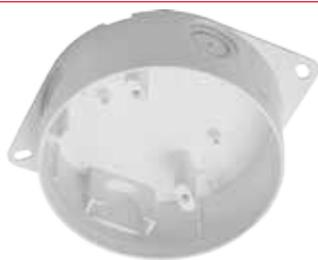
Der Feuchtraum-Sockeladapter wurde speziell für die aP-Kabelzuführung durch Kabelschutzrohre konzipiert und verfügt über drei ausbrechbare Eingänge für M20 Kabelverschraubungen (optional). Geeignet für Meldersockel IQ8Quad, ES Detect. Der Feuchtraum-Sockeladapter hat eine Aufnahme für das Beschriftungsfeld 805576, um den Melder individuell zu kennzeichnen.
