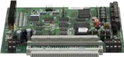
Das serielle essernet®-Interface ist ein Gateway zur Ankopplung von Rechnersystemen, die das EDP (ESSER-Daten-Protokoll) unterstützen. Die Variante EDP (bidirektional) stellt Informationen aus dem essernet® zur Verfügung und eine Fernwirkung ist möglich. Es besitzt einen Steckplatz für ein essernet®-Ringbusmodul und ist damit ein vollständiger Teilnehmer im kurzschluss- und unterbrechungstoleranten essernet®.
