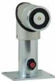
Haftmagnet wahlweise für Boden-, Decken- und Wandmontage geeignet. Der eloxierte Aluminium-Schwenkkopf lässt sich von Wand auf Boden- bzw. Deckenmontage umstellen. Das Rohr ist auf 110 bzw. 145 mm (Boden-/Wandmontage) kürzbar.
