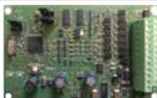
Die Adapterbaugruppe ermöglicht das Absetzen des FBF entfernt vom Montageort der BMZ und die damit notwendige Überwachung gemäß DIN 14661:2011-02 und EN 54-13. Geeignet für den seriellen Anschluss eines FBF an ein paralleles Interface der IQ8Control. Befestigungsmaterial (Haftmagneten) für den Einbau in die BMZ ist Lieferbestandteil.
