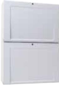
Zusatz-Netzteil zur Erweiterung der systeminternen Energieversorgung. Über eine steckbare Leitungsverbindung ergänzt das Zusatznetzteil das vorhandene Zentralnetzteil mit zusätzlichen 150 W. Zwei Akkumulatoren 12 V/24 Ah finden in dem unteren Gehäuse Platz. Über ein Zusatzgehäuse FX808313 können zwei weitere 24-Ah-Akkumulatoren angebunden werden. Im Netzteilgehäuse können zusätzlich Komponenten auf Hutschienen montiert werden.
