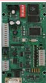
Mikroprozessorgesteuerte Baugruppe zum Einbau in die BMA des Systems 8000 oder IQ8Control. Gemäß DIN 14675 kann mit diesem Adapter die TTY-Schnittstelle der BMZ als redundanter Übertragungsweg ausgeführt werden, wenn das Feuerwehr-Anzeigetableau FAT 3000 zur Erstinformation der Feuerwehr genutzt wird. Vom PC über serielle Schnittstelle programmierbarer Zusatztext (> 4.000 Texte).
