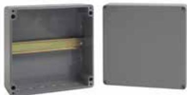
Polyester-Gehäuse für den Einbau von max. 10 Ex-Barrieren mit integrierter Hutschiene (ca. 240 mm) im Innenteil und inkl. Zubehör. Auch für Einsatz unter extremen Umweltbedingungen oder starken mechanischen Beanspruchungen geeignet. Gewinde und Kabelverschraubungen in metrischer Ausführung. Die Befestigung des Gehäuses erfolgt durch isolierte Schraubkanäle außerhalb des Dichtraums.
