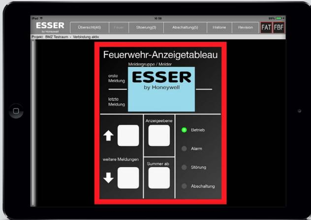
Standardisierte Oberfläche eines Feuerwehr-Anzeigetableaus
